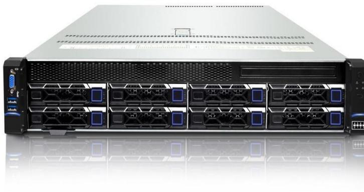
数聚红芯 H6525 是一款具有广泛用途的 2U 双路服务器，搭载 AMD 最新 EPYC 9004/9005 系列处理器，该产品采用模块化设计方式，可根据业务需求进行弹性配置，具备卓越的计算性能和丰富的扩展能力，实现了优异的性价比和能耗比，适用于云计算、虚拟化、高性能计算和人工智能等应用。
